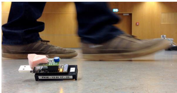
Akustiksensoren zur Detektion von Trittschall während der Evaluation in der Testumgebung
